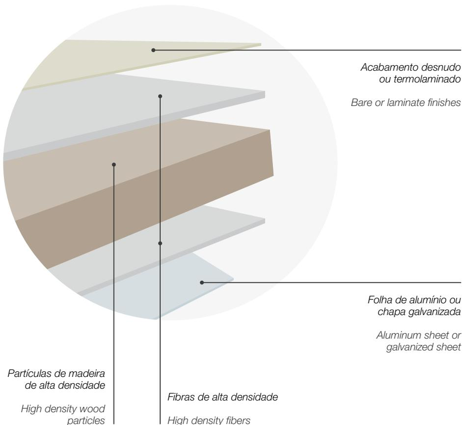
Solum SP é um pavimento com boa resistência físico-mecânica e baixa absorção à superfície composto por fibras e partículas de madeira de alta densidade.
