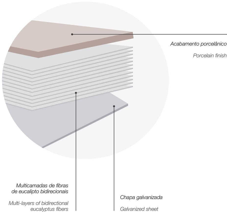
Solum Ceramic é um pavimento com elevada resistência físico-mecânica, à abrasão, à humidade e ao fogo composto por várias camadas de fibras de eucalipto compactadas.
