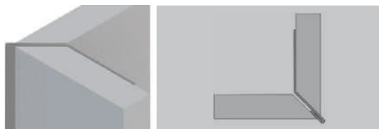
P1 Perfil de Canto a 45° (15 x15 mm / 22 x 22 mm) P1 Miter Profile 45° (15 x15 mm / 22 x 22 mm)
