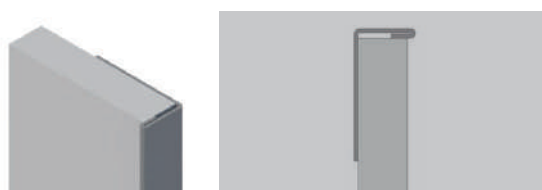
P5 Perfil de Acabamento (15 x15 mm / 22 x 22 mm) P5 Finishing Profile 45° (15 x15 mm / 22 x 22 mm)
